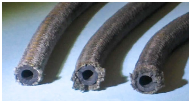
Ny bränsleslang till vänster. Åldrade slangar till höger.
